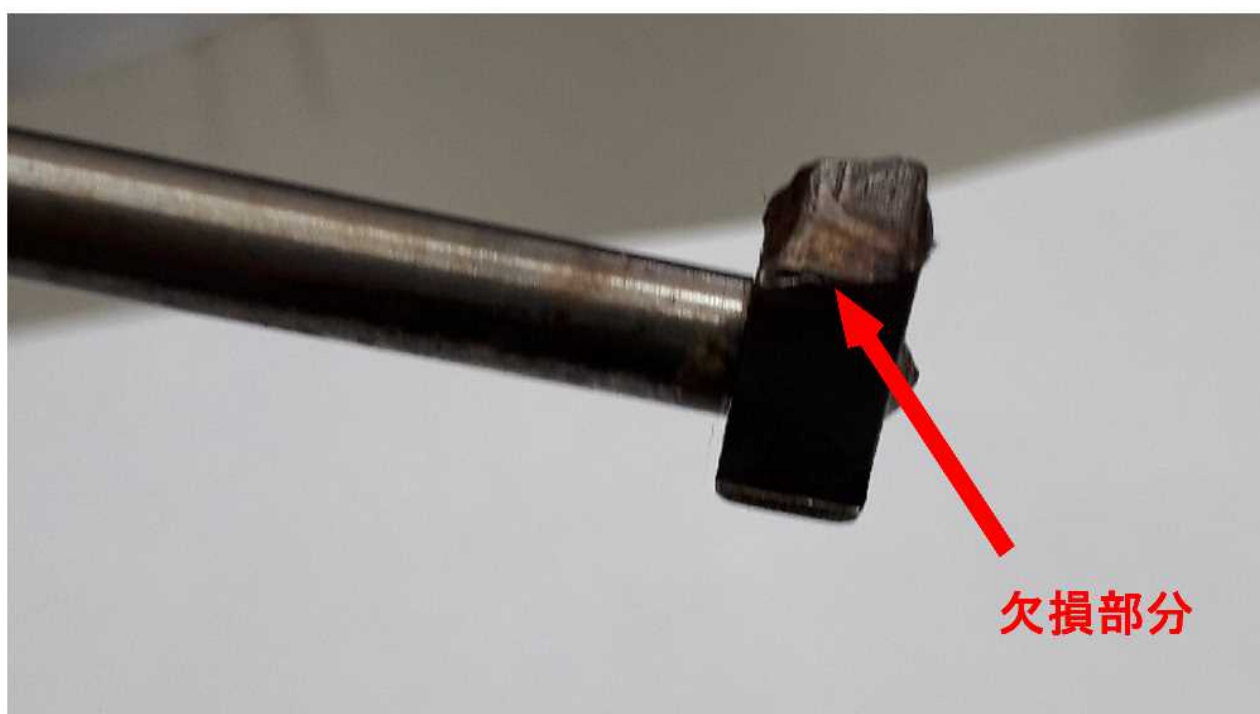
写真5 爪の欠損状況
