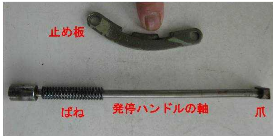
写真3 発停ハンドルの構成部品
