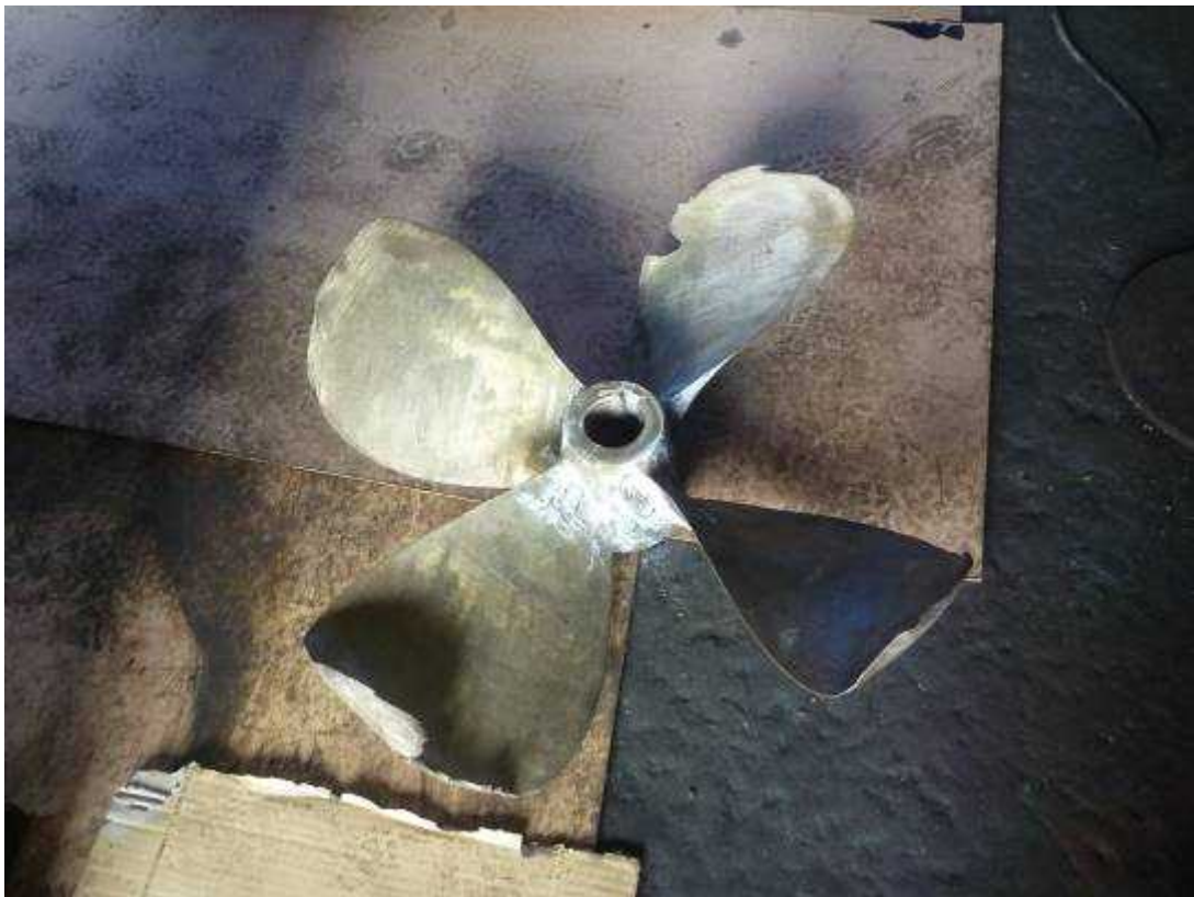
写真2 左舷プロペラ翼損傷状況
