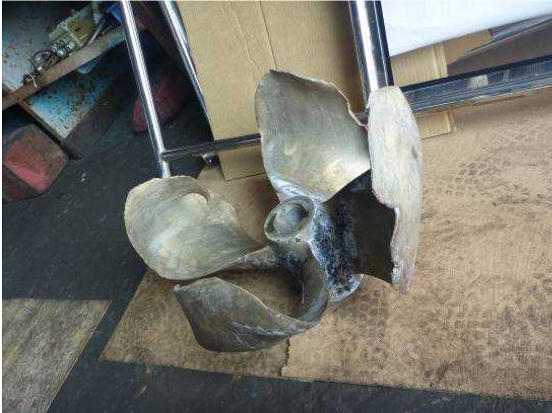
写真1 右舷プロペラ翼損傷状況
