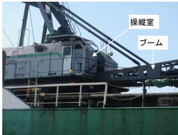
写真3 クレーンの操縦室
