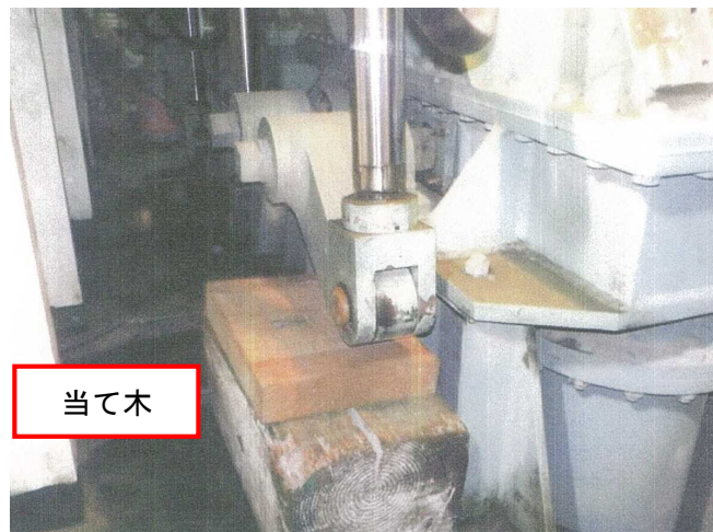
写真3 切替装置のエアシリンダの下に当て木を置いた状態
