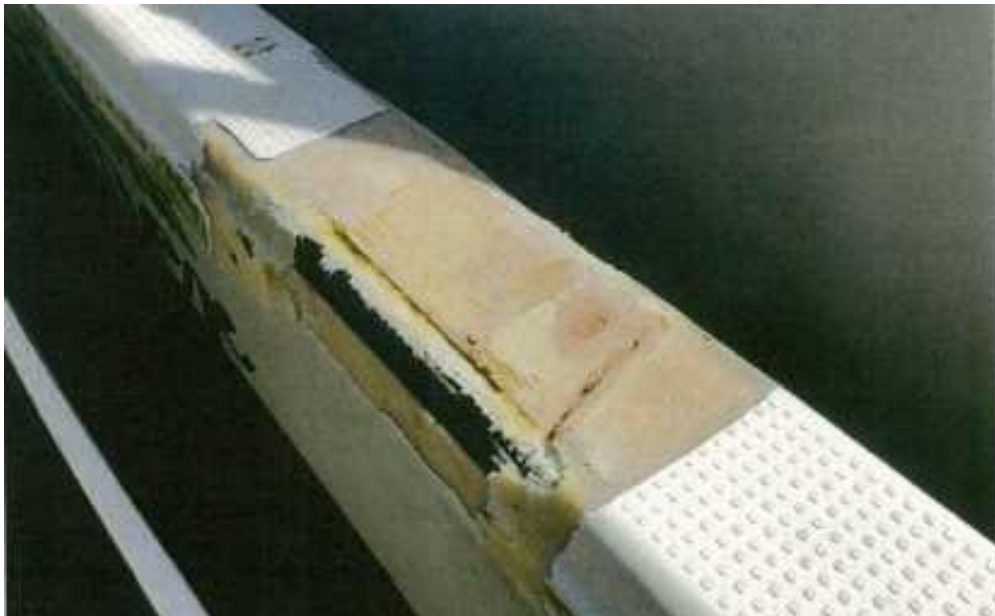
写真5 B船ブルワーク内部亀裂状況
