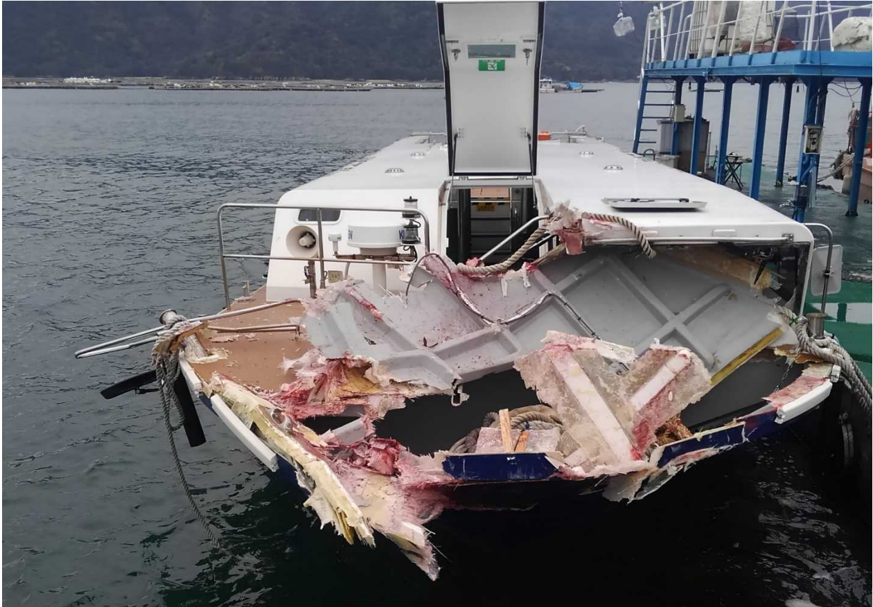
写真1 A船の損傷状況（船首部）
