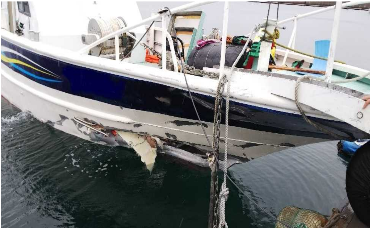
写真2 B船の損傷状況（右舷船首部）
