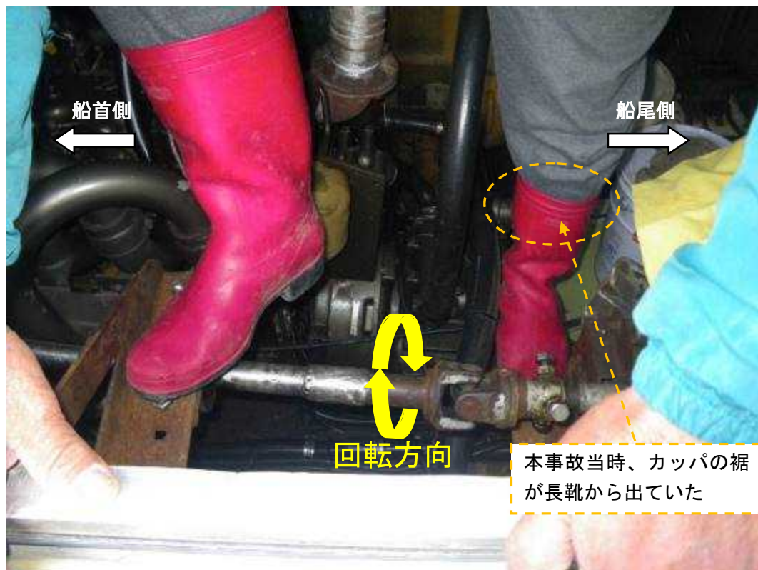
写真4 甲板員Aが機関室から出る時の両足の状況（左舷側から見た機関室）
