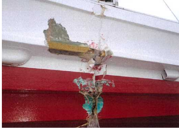
写真6 B船右舷中央部外板破口
