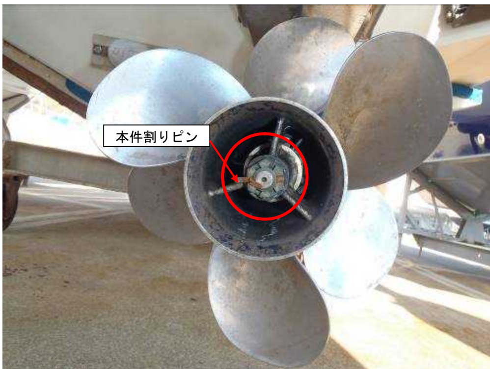
写真2 本件割りピン付近の状況
