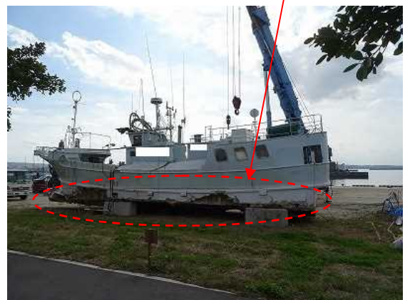
写真2 本船の損傷状況
