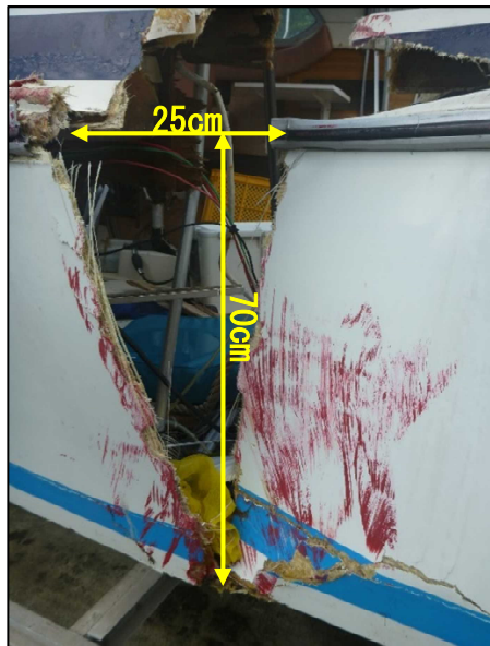
写真2.3-1 B船左舷中央部の損傷状況
