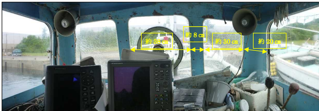
写真2.5-4 A船操舵室からの見通し状況
