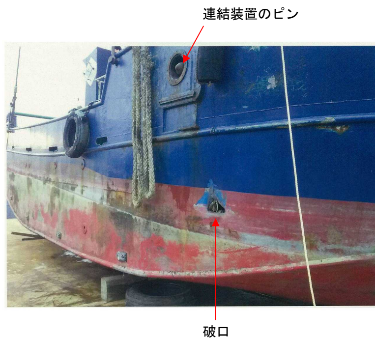
写真1 A船右舷船首部の損傷状況
