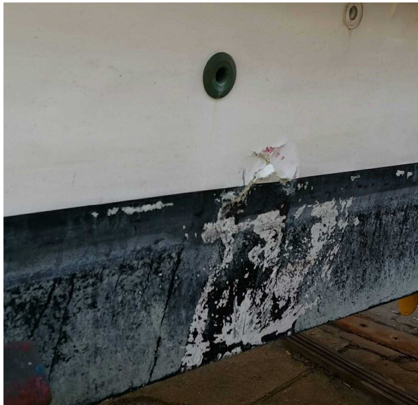
写真4 B船の左舷中央部の亀裂
