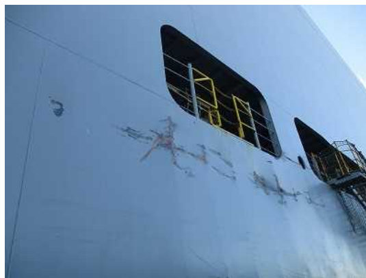
写真2 A船の損傷部（左舷側）
