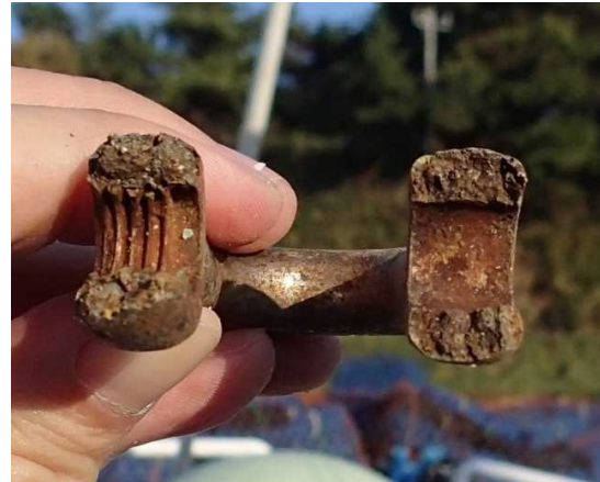
写真5 本件シャックルの破断面
