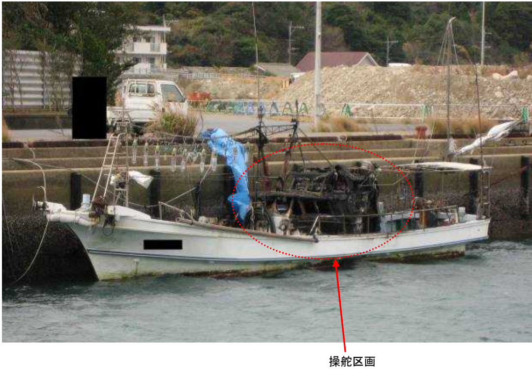
写真1 本船の焼損状況
