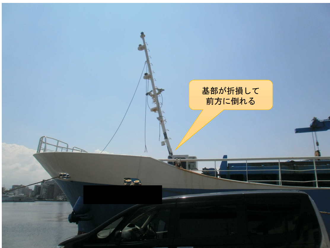
写真2 本船前部マストの損傷状況
