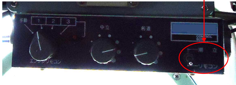
写真2 操舵装置制御盤
