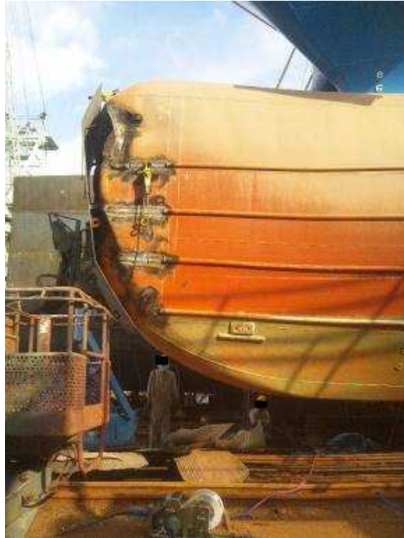
写真1 A船の球状船首部の損傷状況
