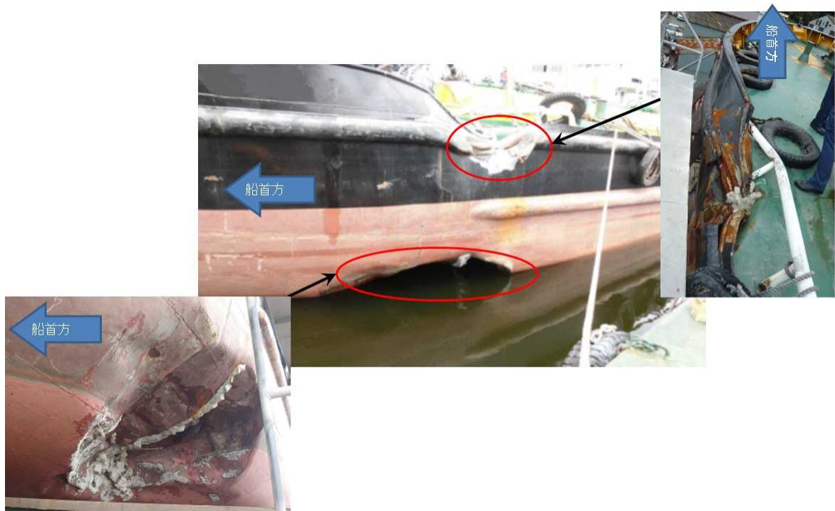
写真 2.3-3 左舷船首部の損傷状況 (B船)
