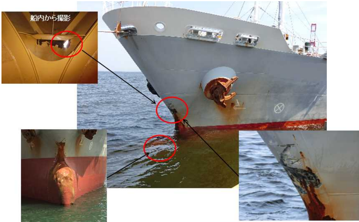
写真2.3-1 船首部の損傷状況 (A船)
