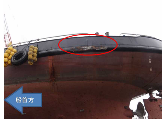
写真 2.3-4 左舷船尾部の損傷状況 (B船)
