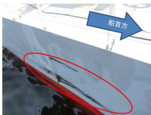
写真2.3-2 右舷中央部の損傷状況 (A船)
