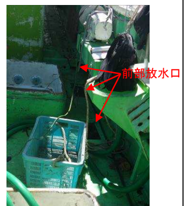
写真7 左舷側の前部放水口
