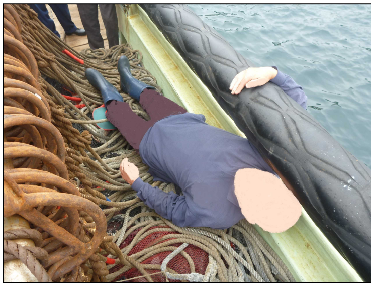
写真3 甲板員Aがサイドローラに巻き込まれた状況（再現）
