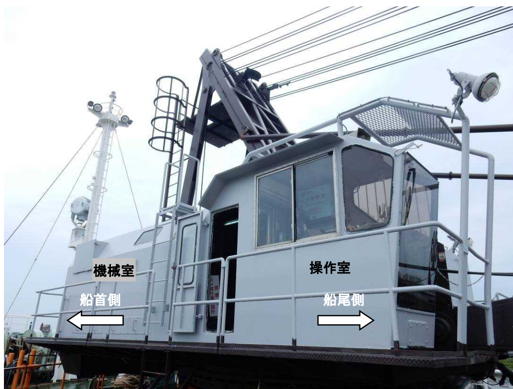
写真2 クレーンの操作室
