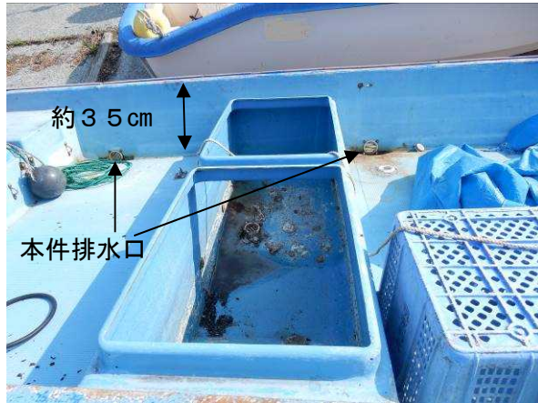
写真2 本件排水口の位置（船内）
