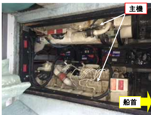
写真8 操舵室内にある機関室ハッチから見た主機 （本事故発生前）
