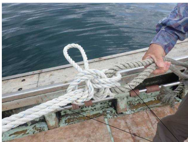
写真3 本件ロープの結び目の状況（再現）
