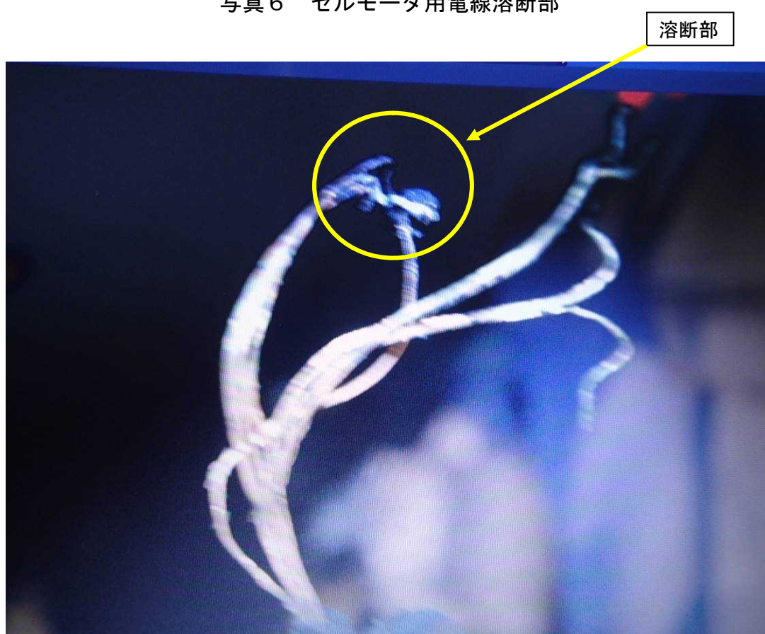
写真6 セルモータ用電線溶断部
