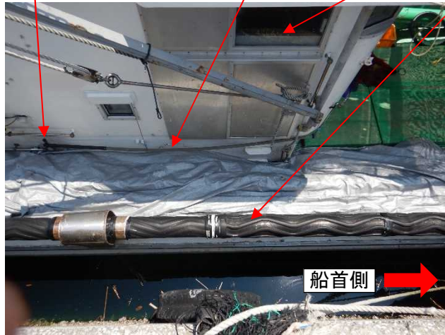
写真1 本件ローラ及び本件操作パイプの状況（上方より）
