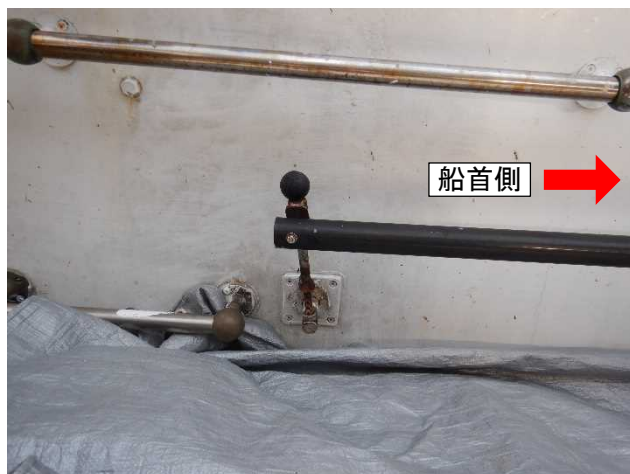
写真3 本件ローラの操作レバーと本件操作パイプとの接続状況
