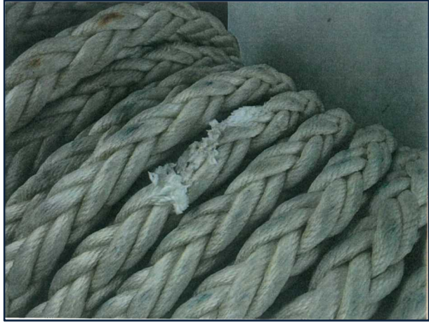
写真2 A船のえい航索の損傷
