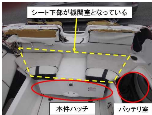
写真4 本件ハッチ及びバッテリー室の状況
