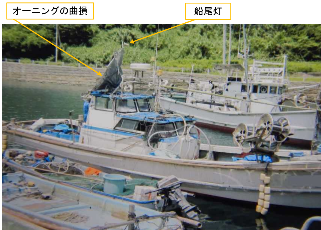
写真3 A船のオーニングの損傷状況
