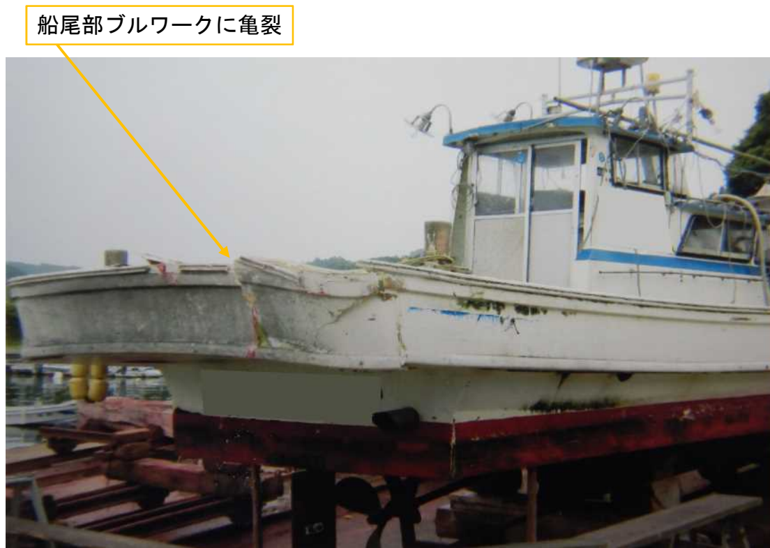
写真2 A船の船尾部ブルワークの損傷状況
