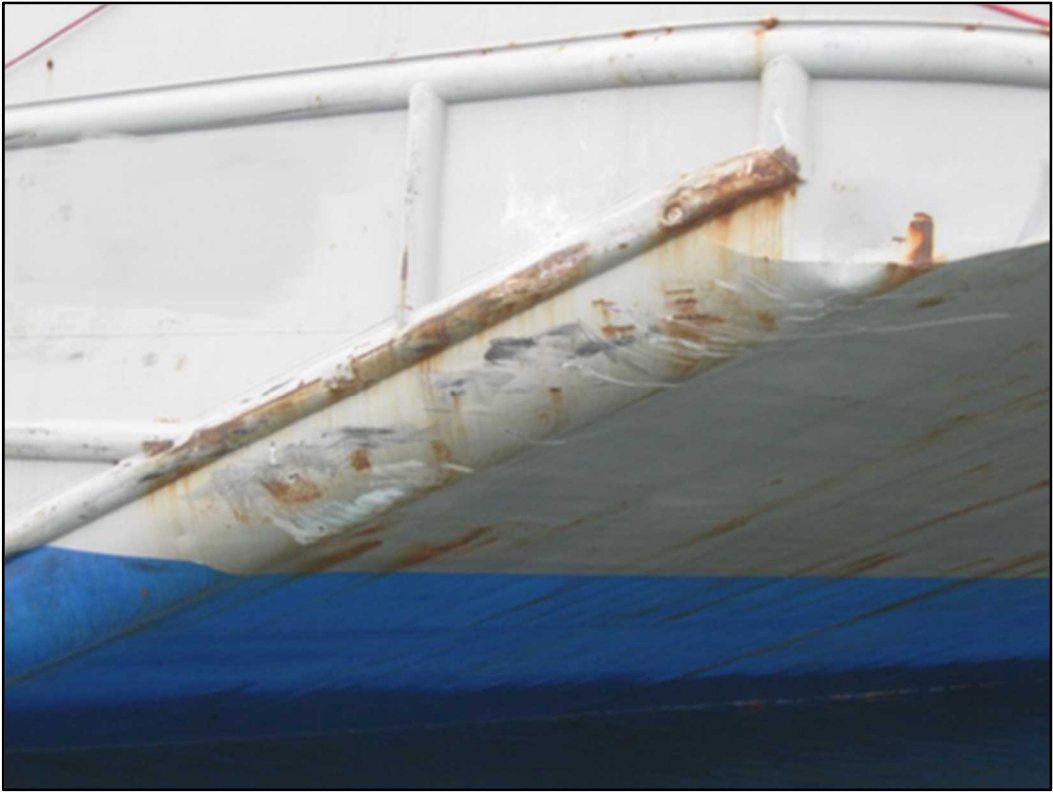
写真1 A船の損傷状況（右舷船首部）
