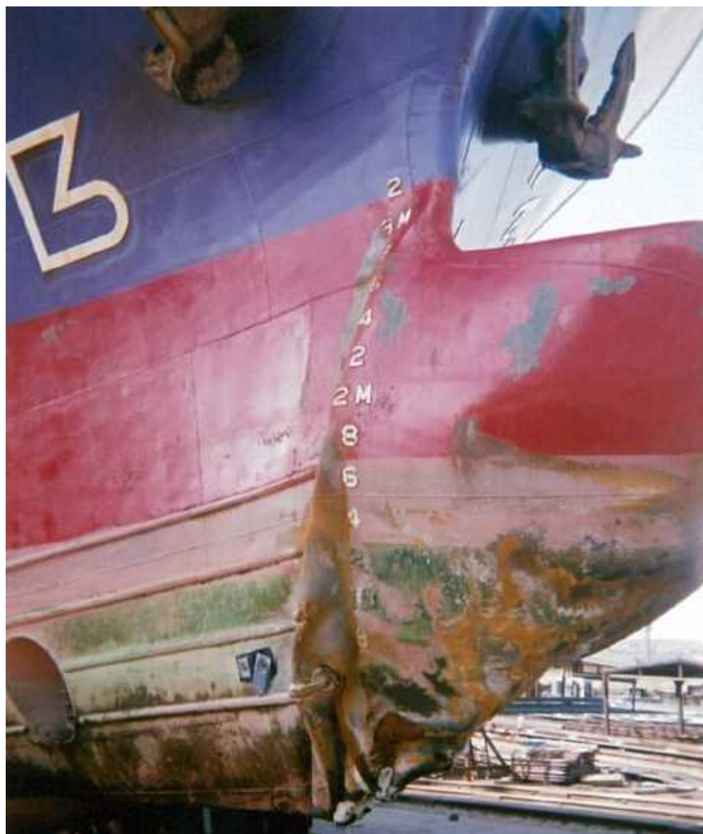
写真1 船首部の損傷状況
