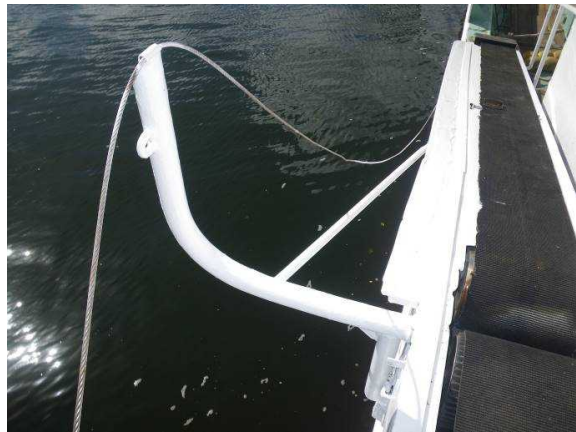
写真4 本船の左舷側のかにかご落下防止ワイヤ支持アーム（修理後）
