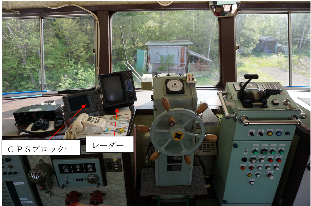
写真3 航海計器類及び前方見通し状況
