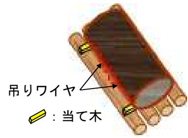
図5 本件木材の当て木の状況
