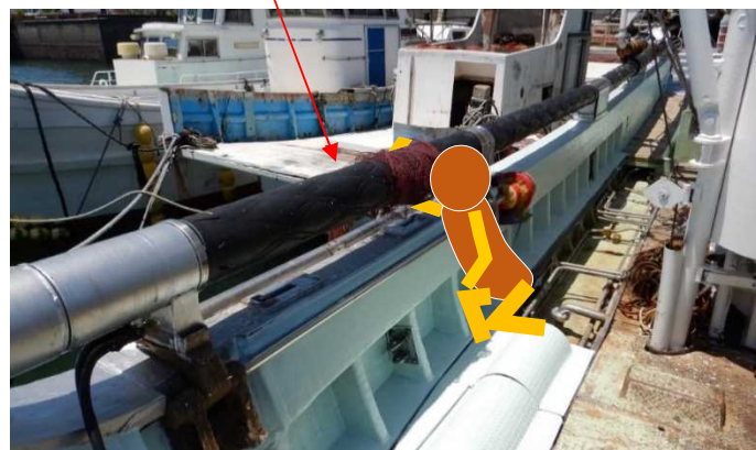
写真3 船長が本件ローラに巻き込まれた状況
