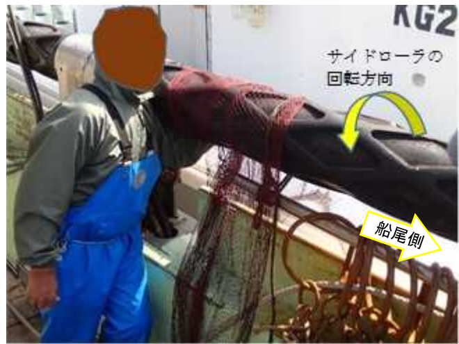
写真3 甲板員Aがサイドローラに左腕を巻き込まれた状況
