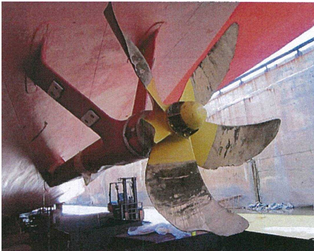
写真2 プロペラ翼（右舷）の欠損の状況
