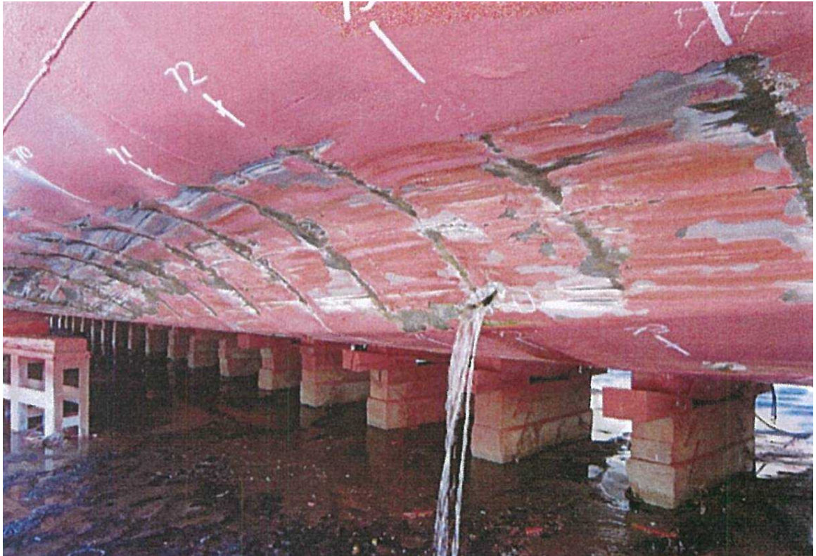
写真1 船首部船底の破口の状況
