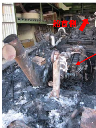
写真3 焼損状況 (機関室①)
