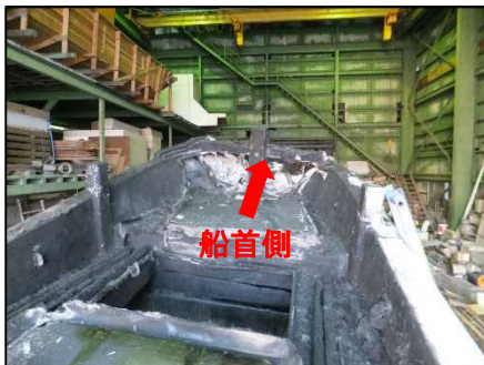
写真1 焼損状況 (船首側甲板上)
