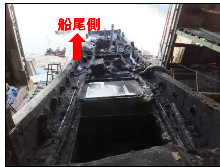
写真2 焼損状況 (船尾側甲板上)
