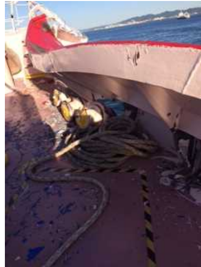
写真2 B船の右舷船首部のブルワーク及びフェアリーダの損傷状況
