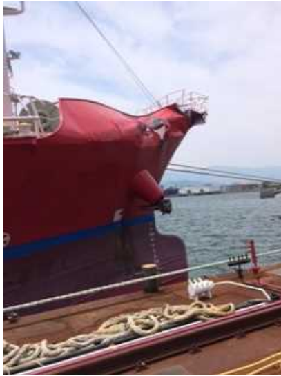
写真1 B船の右舷船首部のブルワークの損傷状況
