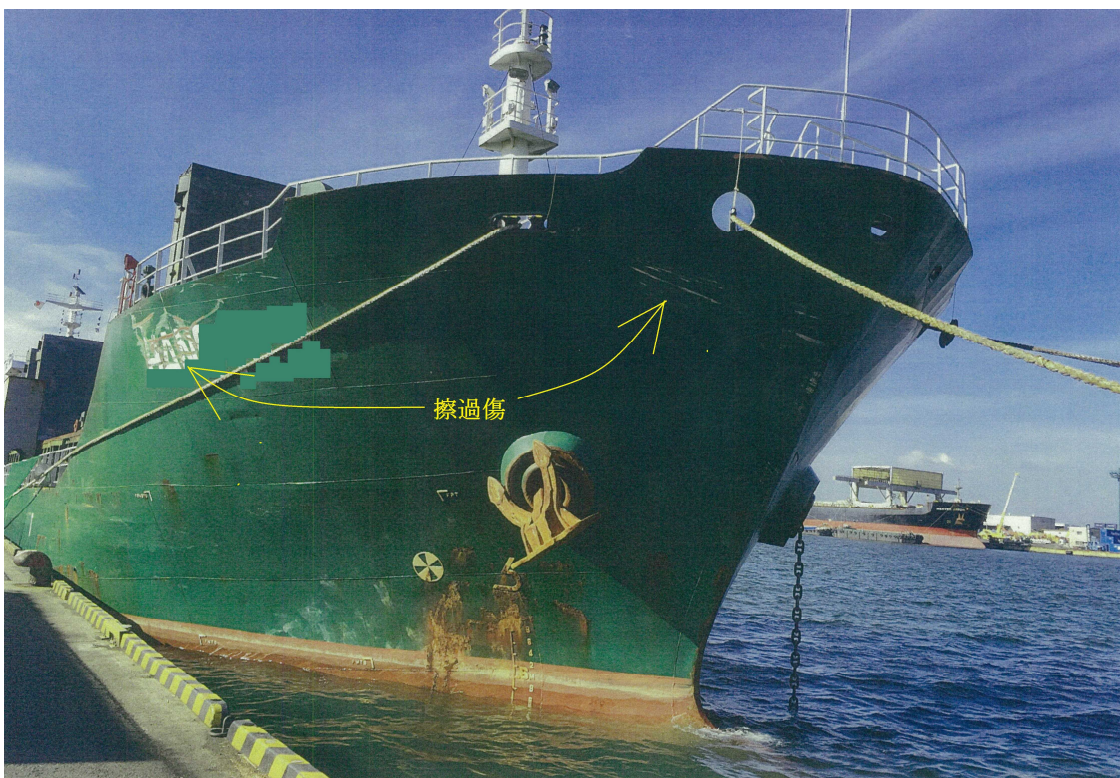
写真2 B船の損傷状況
