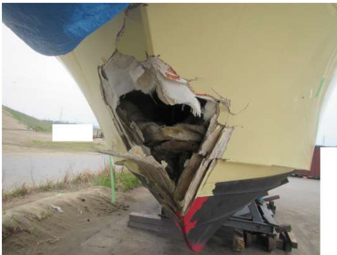
写真2 船首部船底の損傷状況
