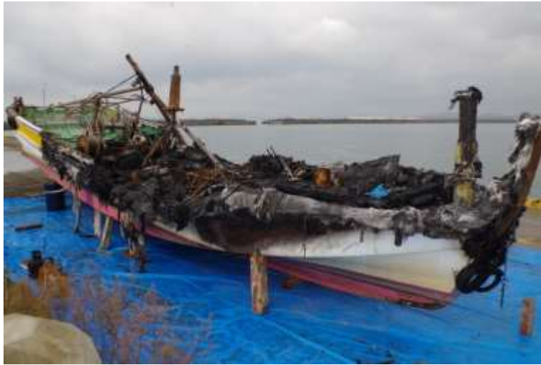
写真1 焼損状況 (右舷前部)
