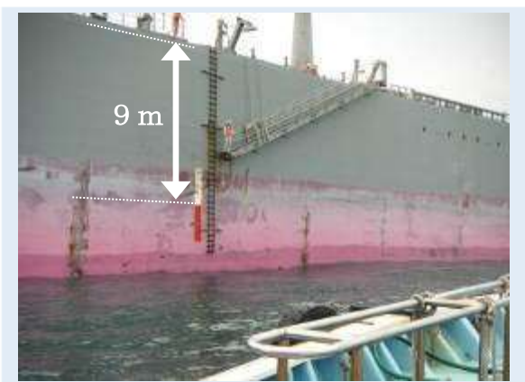
写真2.8-1 水先人用移乗設備の一例（日本水先人連合会提供）
