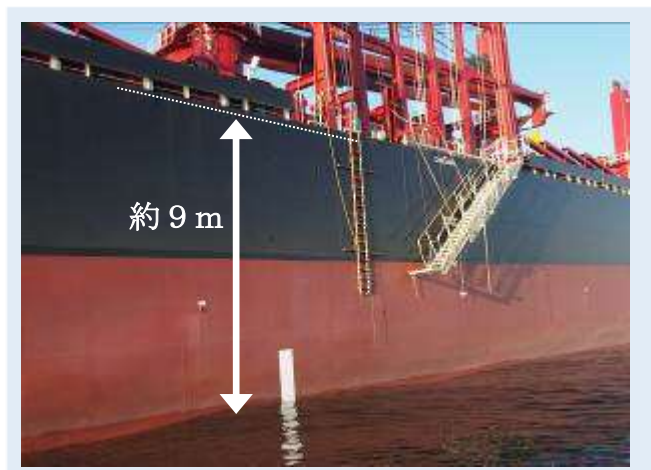
写真2.8-2 本船の水先人用移乗設備
