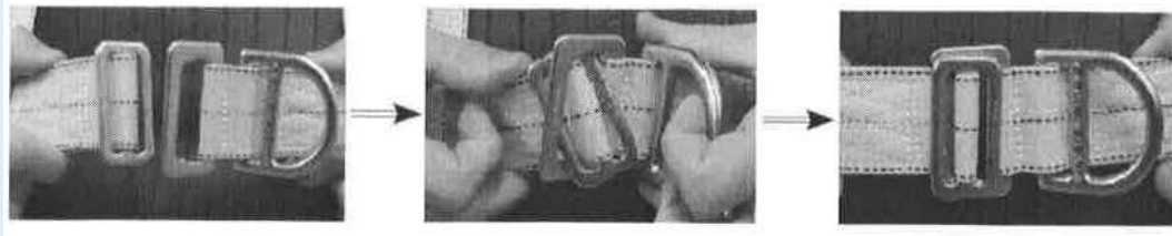
一方の金環を斜めにして、他方の金環に通す
