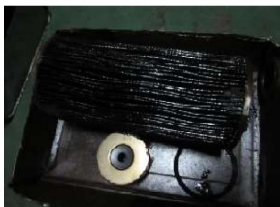
写真2 A船燃料フィルタの汚れ
