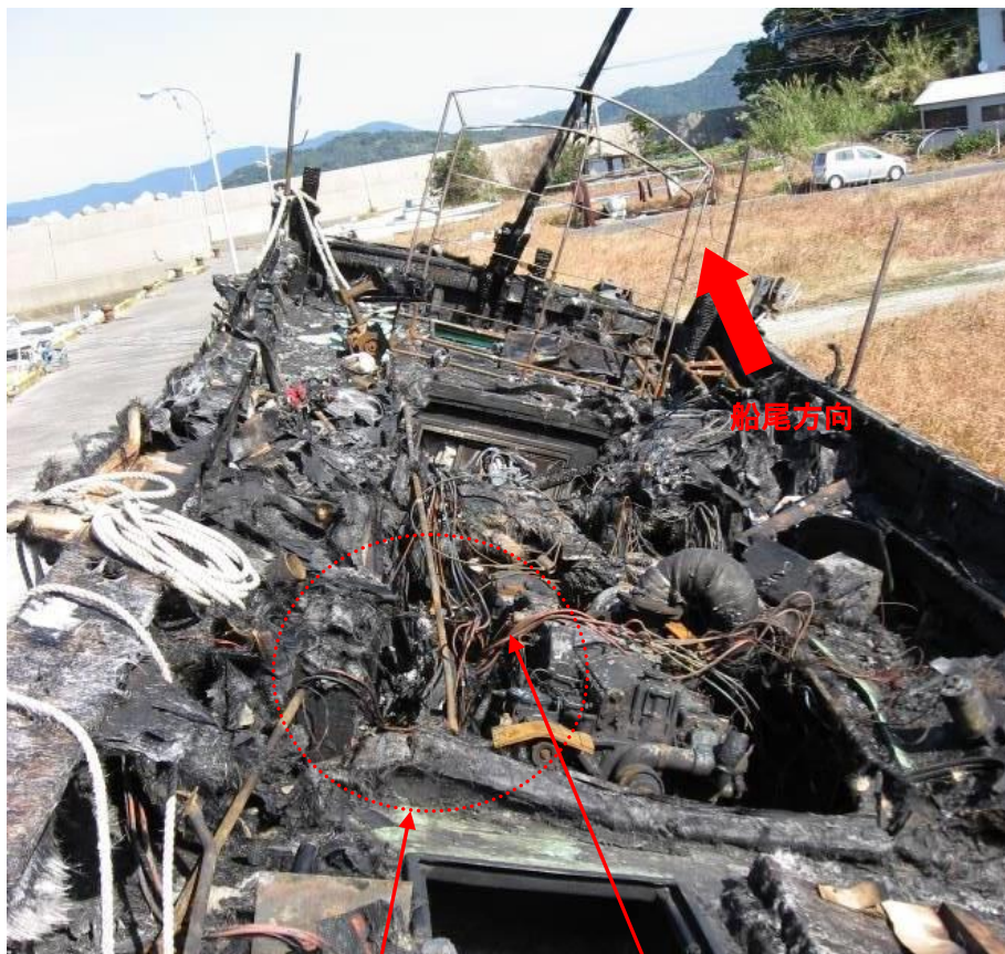
写真2 機関室の焼損状況
