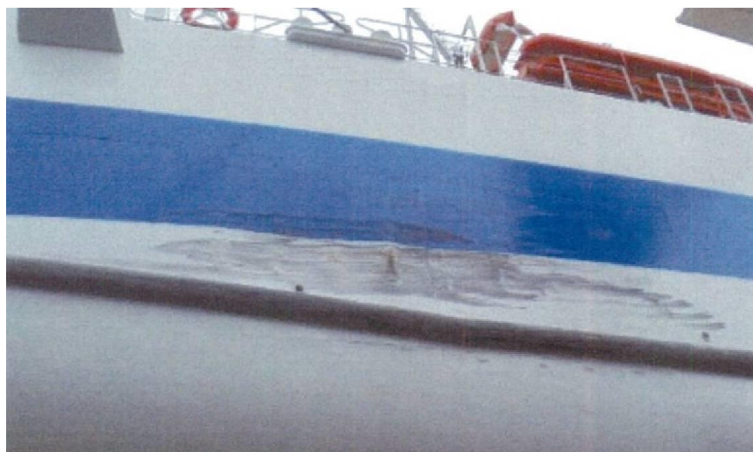
写真2 右舷船尾部外板の損傷状況
