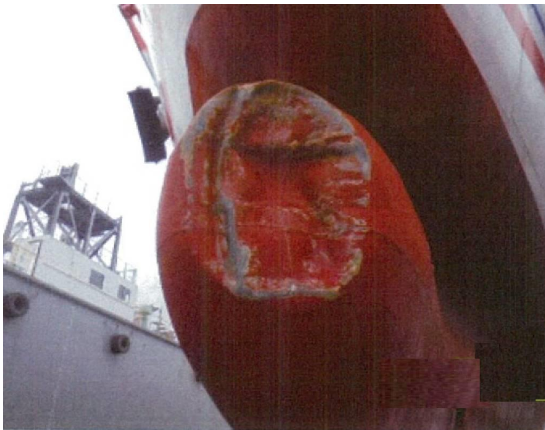
写真1 球状船首の損傷状況
