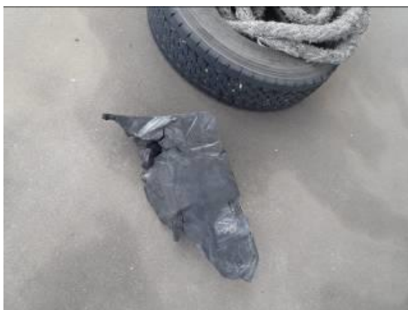
写真3 破損した本件防舷材の一部
