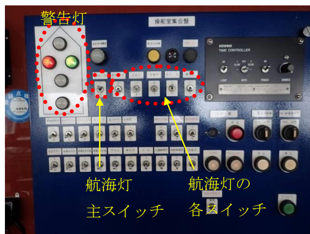
写真 2.5-3 A船の航海灯のスイッチ
